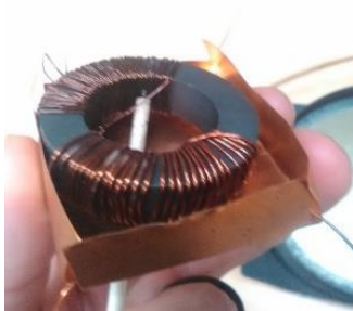
Рис. 9 – Горячий спай термопары равноудален от нижней и верхней поверхностей ферритового кольца.
