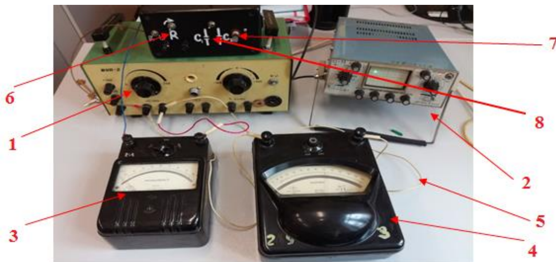
Рис. 6 – Внешний вид лабораторной установки по исследованию электрических релаксационных колебаний: 1 – источник тока ВУП-2, 2 – осциллограф С1-73, 3 – миллиамперметр, 4 – вольтметр, 5 – соединительные провода, 6 – переменный резистор, 7 – неоновая лампа, 8 – два полярных конденсатора.
