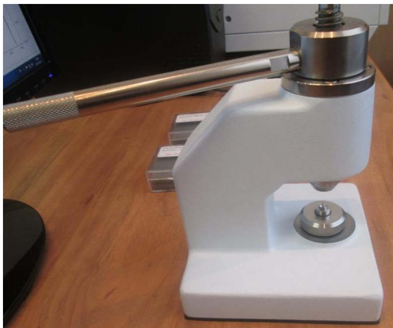
Рис. 15 – Пресс для холодной сварки тиглей.
